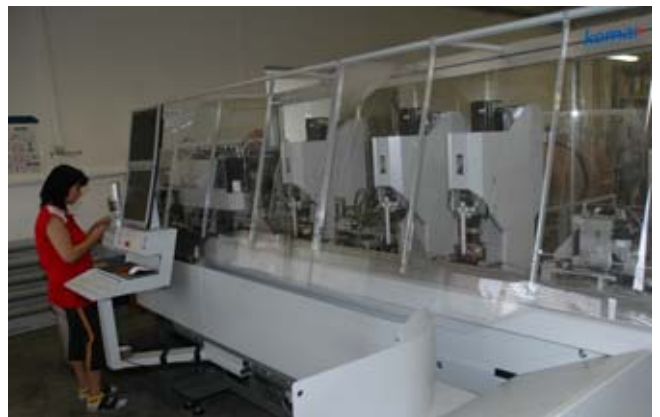
Blockloader Zeta 633/655 mit automatischer Gehäusezuführung im Einsatz
