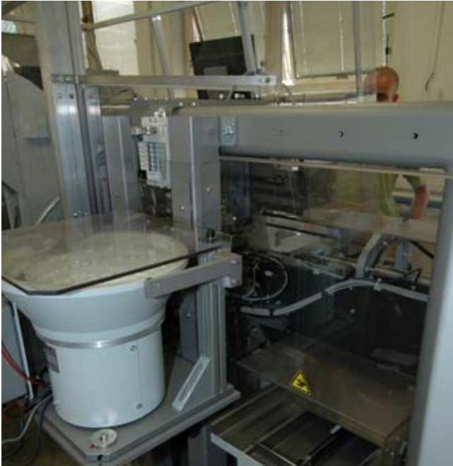
Rütteltopf zur automatischen Gehäusezuführung
