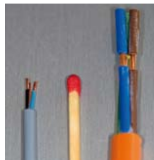
Kappa 321: Kabelmuster mit sehr kurzer Abmantellänge
